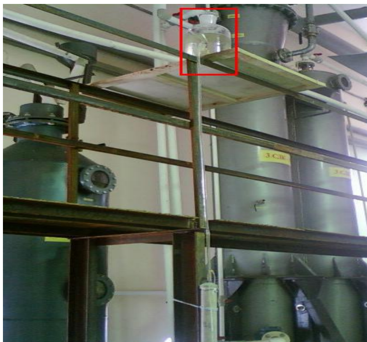
Рисунок 12 – Установка для эксперимента по определению ПДОЕ микросфер – падающая емкость
