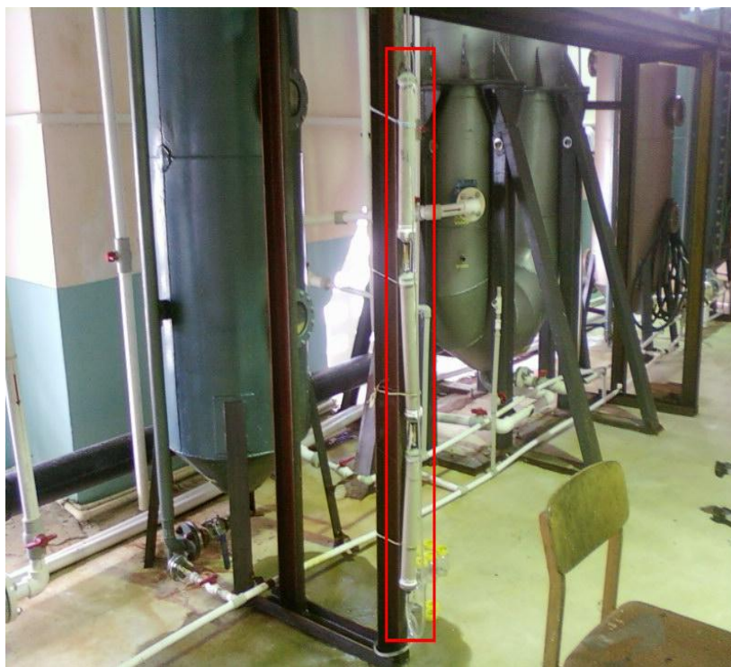
Рисунок 10 – Установка для эксперимента по определению ПДОЕ микросфер с тремя сорбционными колонками
