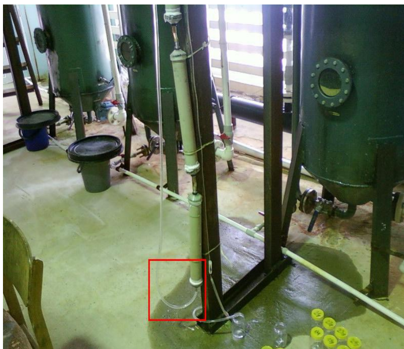
Рисунок 11 – Установка для эксперимента по определению ПДОЕ микросфер – направление подачи раствора снизу вверх
